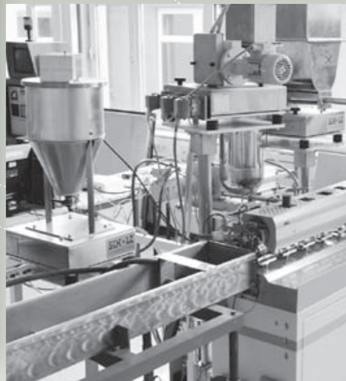
↑ Doppelschneckenextruder: Herstellungsverfahren zur Verbesserung der Bioverfügbarkeit von Arzneistoffen
