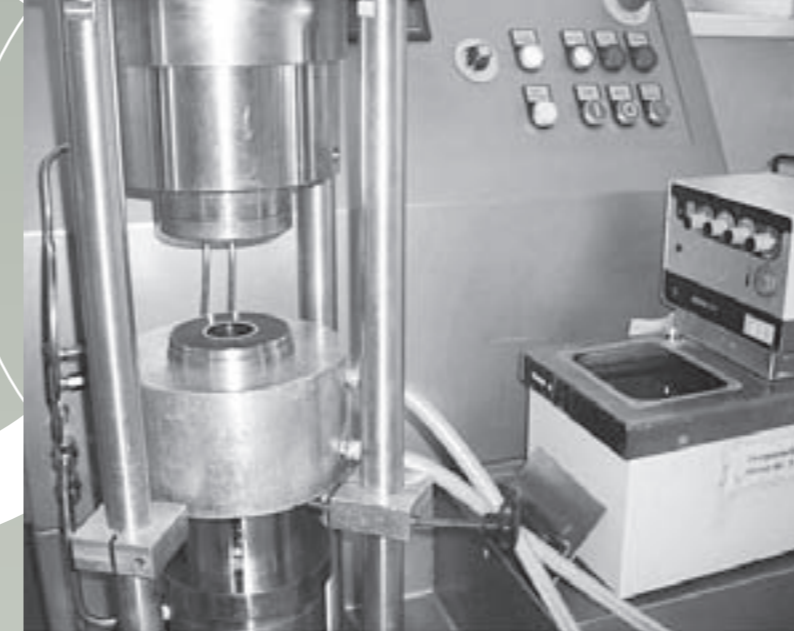
↑ Hochdruckhomogenisator zur Herstellung von Arzneistoffnanocarriern zur verbesserten Wirksamkeit
